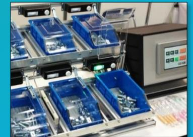
現場力を鍛える手段として、あらためて注目されているのが簡易自動化です。簡易自動化はモノの重力や、てこの原理などの“からくり機構”とモーターなどの動力や簡単な制御機器(センサーなど)を組み合わせて、低コストかつシンプルに自分たちで簡単な自動化設備や装置をつくるものです。生産性や安全性の向上、省人化、作業負担軽減など製造に直結する効果だけでなく、知恵や工夫を凝らしていくことによって現場が活性化するなどの効果もあります。また、より進化させ続けていくことで、自社の技術力をさらに強化することができます。
